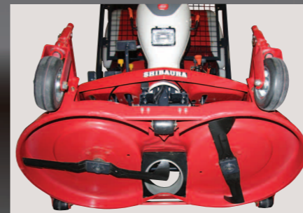
Die hervorragende Schnittqualität wird durch zwei gegenläufig angetriebene Messer erreicht. Mähwerk und Winkelgetriebe werden Keilriemenfrei über Wellen angetrieben.
