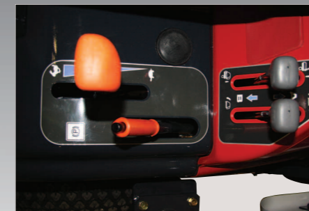
Zwei Bedienhebel zum Ausheben und Entleeren des Grassammelbehälters. Standard Tempomat.
